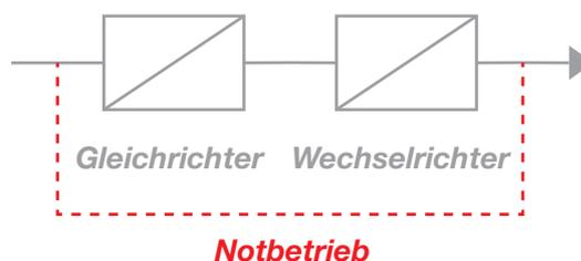
Gegenüber dem klassischen separaten Bypassschalter werden durch die hier verwendete integrierte Lösung **Kosten und Installationsarbeiten gespart**.
